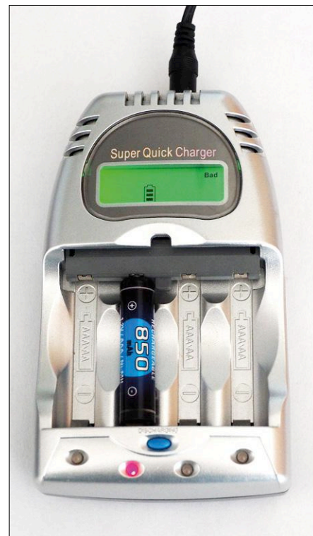
Figuur 11. Intelligente snellader voor vier NiCd- of NiMH-cellen van het formaat AA en AAA met een stroom tot 0,8 C, deze herkent zelfs defecte cellen. Met een druk op de blauwe knop worden de accu's voor het laden eerst ontladen.
